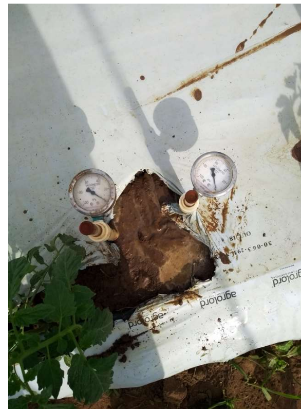
Instalação de tensiômetros para acompanhamento da umidade do solo
